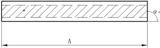
▶ 与筛网切割处的应力控制管一起使用，提供精确定义的阻抗特性，使电场平滑
