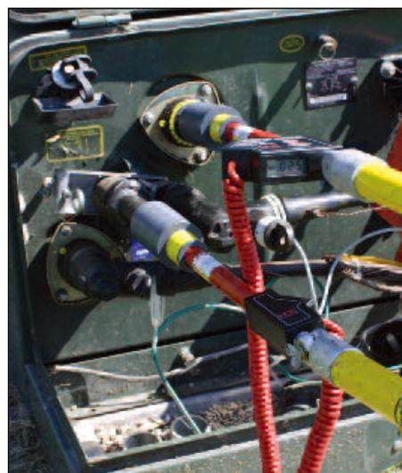
DVM-80UVM是一种紧凑型高精度双探针电压表，具有峰值保持模式，可用于电压检测和核相。DVM-80UVM测量的电压范围为5V到40kV，如加配高压电阻棒可用于最高80kV电压系统。可用于架空设备和地下设备。
