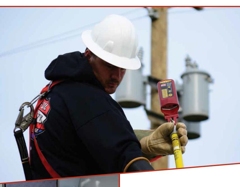
PRX 非接触式验电器可以在不接触导体的情况下验证是否存在电压。
